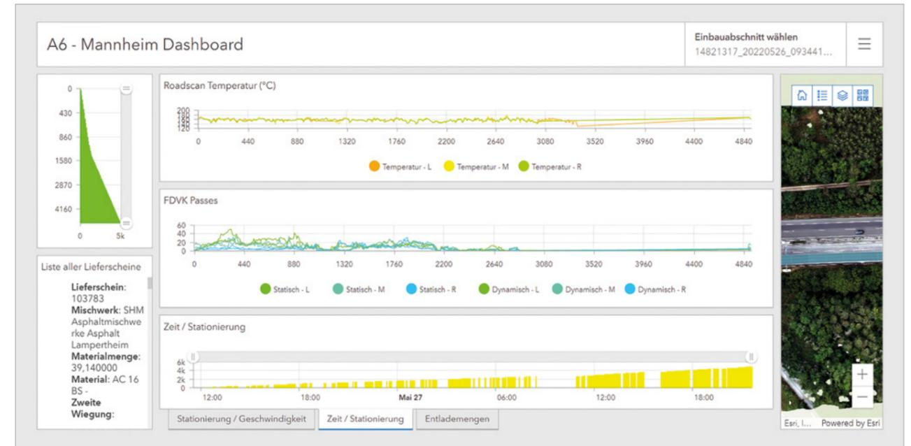
Dashboard mit allen relevanten Attributen zum Asphalt
